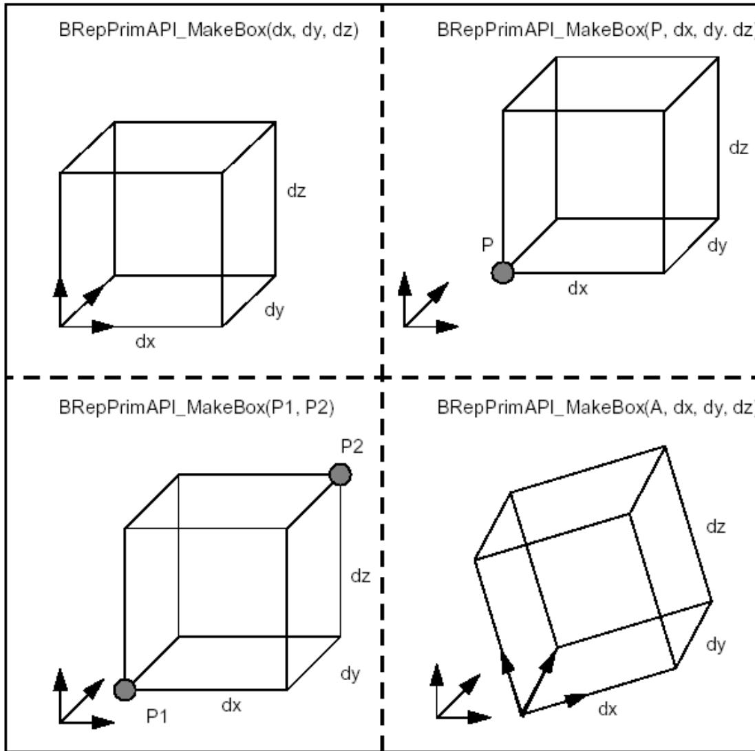
以上创建方式对应类的 **BRepPrimAPI\_MakeBox** 的四种构造函数：
